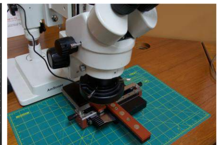
実体顕微鏡との併用による高精度な位置合わせ
