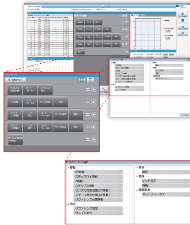
3ポイント測定シーケンス設定の場合(X・Y軸2点、Z軸1点、終了後サンプル位置へ移動)
