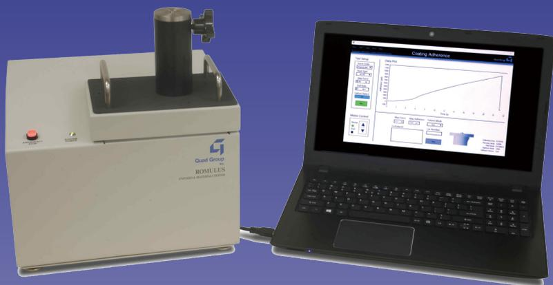
**Romulus** は薄膜など各種材料の表面に関する強度試験・評価の為にコンピュータ制御のテスターです。様々な形態の密着強度測定、薄膜製造のマイクロエレクトロニクス工程検査、材料の性質検査、各種コーティング膜の試験等、表面の密着強度を簡単に評価できる世界標準機器です。
