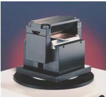
硬質材料の曲げ強度
