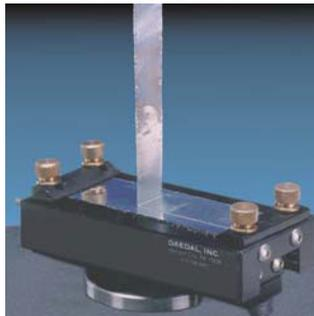
硬質基板剥離強度
