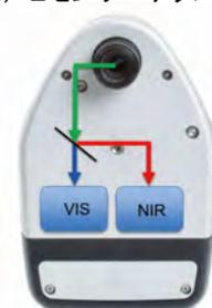
基本測定原理は、測定対象物に照射した光が反射され波長毎に HSI カメラに取得され、それらの各波長データに XY の各ピクセル情報を組み合わせてデータキューブを作成しソフトウェアで解析します。(図3) 光を細かく分光撮影しデータを蓄積することにより非接触・非破壊・高速・高解像度の最大 1000 バンドデータから肉眼で見えない情報を可視化し、波長毎の面分光データキューブを構築することにより多彩なアプリケーションに対し真の面分光画像情報を提供致します。(図4)
