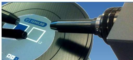
有機薄膜 膜厚・屈折率 測定
