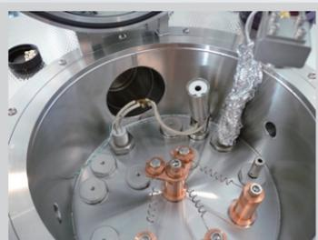
LT026A-TE3蒸着源, LTE有機蒸着源
