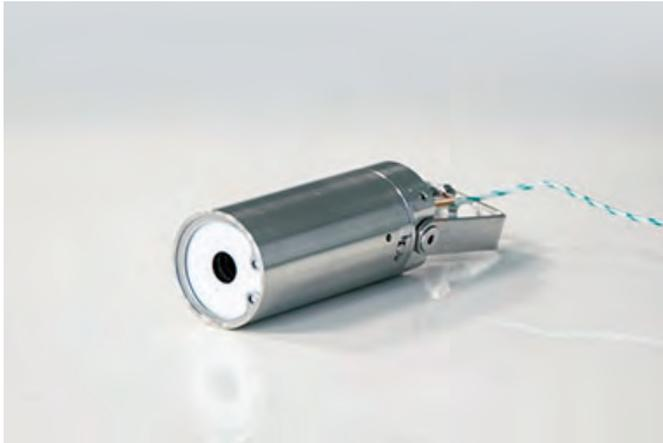
高精度での低温制御 (<600°C) が求められる有機薄膜に最適。安定した温度制御、応答性にも優れた有機蒸着源。水晶膜厚モニタとの組合せで、PIDループ自動制御で約 ±0.1 Å の膜厚制御が可能。
