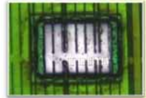
IC保護膜・メタル層の除去
