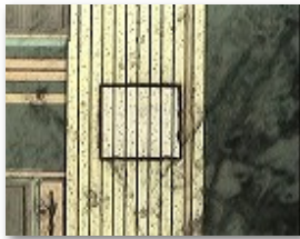
ポリイミド膜除去 (メタル表面露出)
