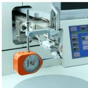
プルテストユニットはプルゲージをヘッドに取付けて、Z軸マニュアルレバーで操作する簡易タイプのプルテスターです。
