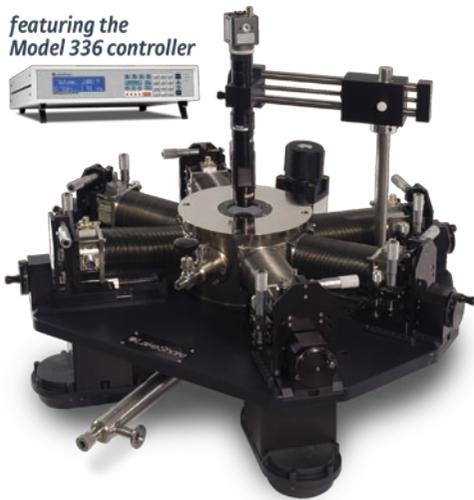
TTP (Table-Top cryogenic Probe station) X型は卓上コンパクトな設計に6本までのマイクロマニピュレータを装備した極低温プローバーです。TTPXは極低温環境下での電気特性、光物性評価が可能で、直径51mmまでのサンプルや多数のデバイスをウェーハ上に作成した場合も切り出しやワイヤボンディングなしで電気測定が可能です。
