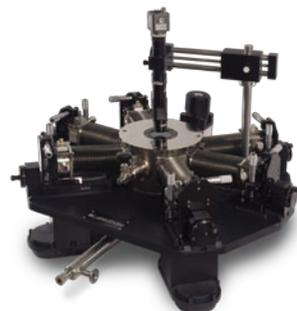
ケースレー社 4200 型の User Library Module に温度コントローラ 336 制御機能を付加。測定したい温度をあらかじめリスト設定しておけば、温度スイープを開始、設定温度に到達、I-V 測定等開始、と電気特評価の自動化が可能です。
