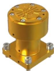
サンプルの向きを 360 度変えられる回転式のサンプルステージです。磁場の方向に対してサンプルの角度を変える測定をする場合に使用します。また、この回転式ステージを使えば高周波測定をする GSG プローブの角度を決めることもできます。回転式ステージの上面とサンプルステージの温度センサーの間にある温度勾配は全温度範囲において 2K 以下です。プローブステーションから回転式サンプルホルダーを取り外せば標準のサンプルホルダーを使用することが可能です。
