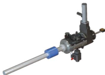
この PS-LL-CPX 型オプションを使えば真空チャンバーの真空を破ることなく、放射シールドを冷却したままの状態ですぐにサンプルの交換ができるようになります。実験と次の実験の時間間隔が 1 時間程度になるため測定の効率が大幅にアップします。温度制御中にもサンプルの交換ができます。
