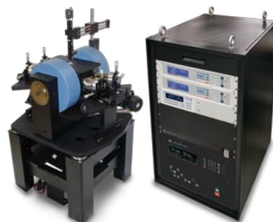
FET の様な 3 端子デバイスの場合、2400 でゲートバイアス、6430 でソース - ドレイン間 I-V 測定の温度依存性を自動化できます。ダイオード等の 2 端子測定にも両機種対応します。上図の様に EMPX-HF 電磁石搭載プローバと連動させることで磁場制御も自動化できます。
