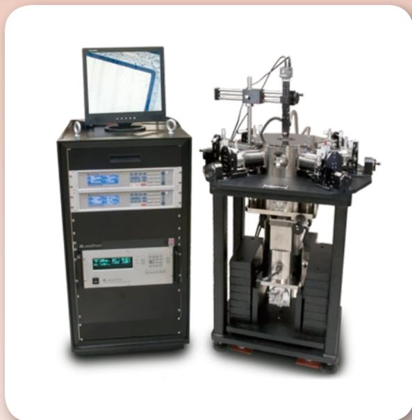
CRX-VF は CRX-4K 型機械式冷凍機プローブステーションに超伝導マグネットを搭載し、2.5T 垂直磁場の環境を兼ね備えたプローバーです。これにより、低温だけでなく磁場環境での物性測定が可能になりました。
