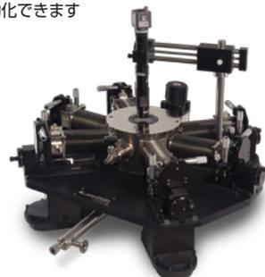
LakeShore 社 低温プローバは周波数応答の標準が上限 50MHz (67GHz 高周波オプション有)。ウェインカー社 6510 型 インピーダンスアナライザを接続、10MHz までの周波数依存性評価を温度自動化にて測定できます。40Vdc 内蔵オプションにより容量 - 電圧特性も制御可能です。
