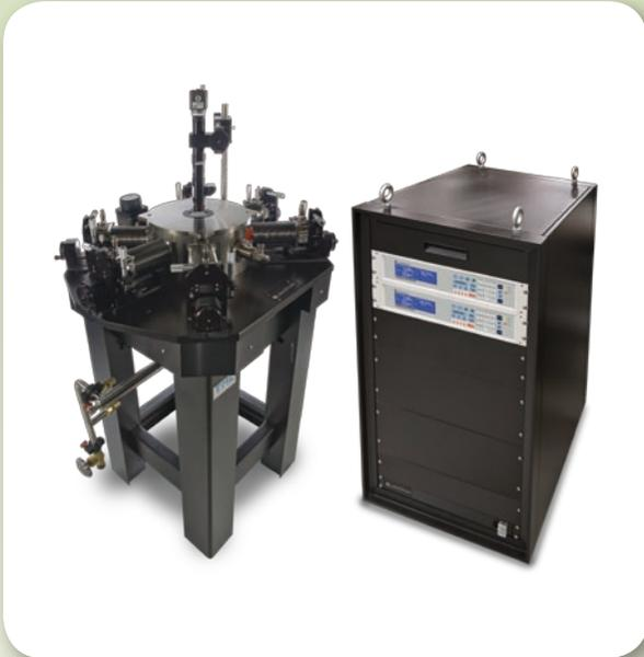
CPX 型高真空極低温プローブステーションは、TTPX に比べ放射シールドを多段階で備えることにより温度安定度が高まり、さらに冷媒の消費量を少なくしています。また、豊富なオプションも用意しています。オプションとして、より低温な温度範囲の 1.5 K ~ 400K もしくは高温な温度範囲の 20K ~ 675 K、高真空 ( $10^5$  Pa)、ロードロック機構、振動遮断システムなどがあります。
