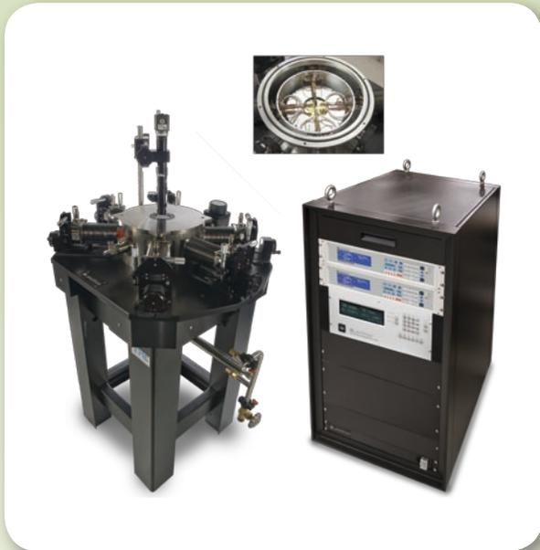
CPX-VF型はCPX型プローブステーションに超伝導マグネットを搭載し2.5T垂直磁場の環境を兼ね備えたプローバーです。これにより低温だけでなく磁場環境での物性測定が可能になりました。また、オプションとして、2.0K～400K、液体窒素デュワーキット、高倍率顕微鏡、真空ポンプシステム、光ファイバー用プローブアームが用意されています。
