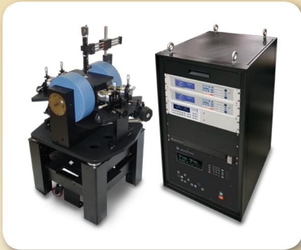
EMPX-HF 型は横磁場 0.6T の電磁石電源を搭載したマイクロプローバーです。またオプションによりサンプルステージが 360° 回転するので磁場の角度依存性の測定が可能です。また、プローブアームは 4 本まで可能です。
