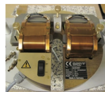
標準電磁石 (360° 回転電磁石) (10 -4 T ~ 1.4T)
