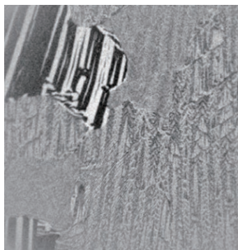
方向性電磁鋼板研磨面の Direct Kerr 像 (約 20 \mu m 角)
