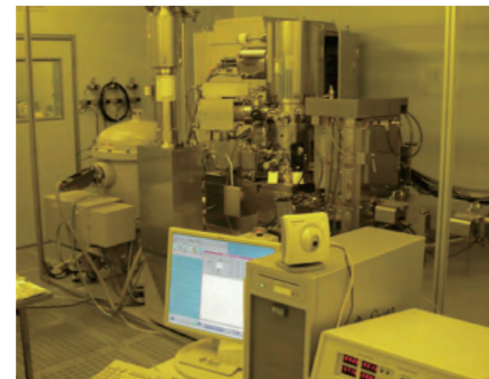
日本電子製 電子ビーム露光装置 JBX-6300の外観図 加速電圧は50/100keV、実測位置合わせ誤差は \sigma < 3\text{nm} 以下。 Electron Beam Lithography System JEOL JBX-6300. Acceleration voltage is 50/100 keV. Measured overlay accuracy \sigma is < 3\text{nm} .
