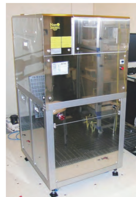
マスクレス露光装置(ナノシステムソリューションズ, DL-1000) Maskless lithography system (Nanosystem Solutions D-Light DL-1000)
