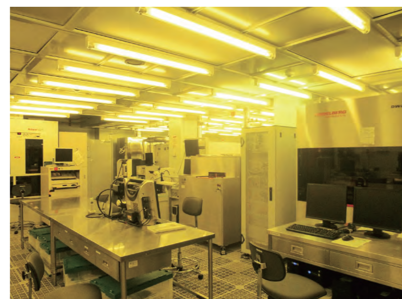
イエロールームの装置群右手前からレーザー直接描画装置、高速マスクレス描画装置、正面奥にステッパー。 From front right, laser pattern generator, high speed maskless LED lithography, and i-line stepper.
