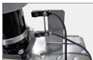
安全対策用近接センサー 手動バルブに取付可能、お問い合わせください。
